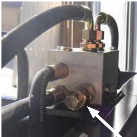
Pilotstyrd backventil med överströmningsventilen markerad med pil.
