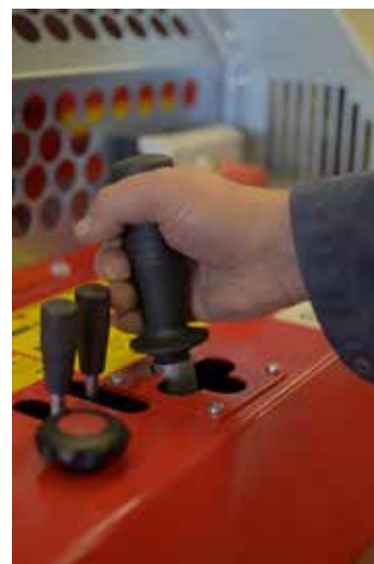
För joysticken från dig tills stockhållaren har släppt stocken
