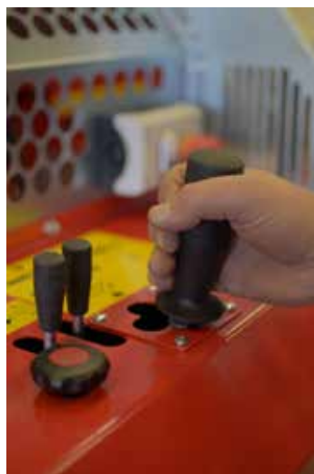
Drag joysticken mot dig för att kapa stocken
